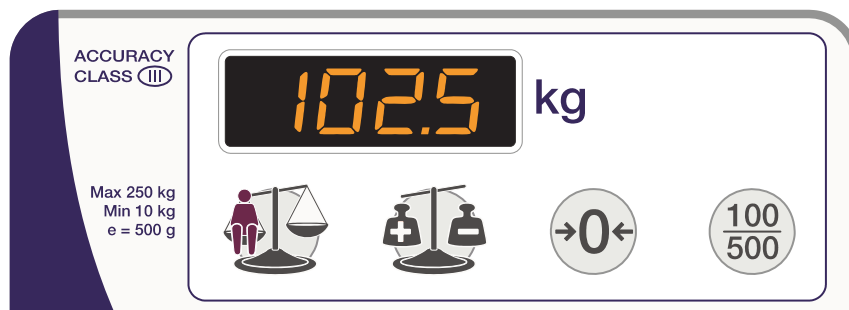
Rys. 21 - Sterowanie systemem ważenia pacjenta
