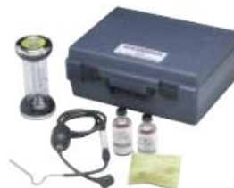
Fyrite – przyrząd do pomiaru CO 2
