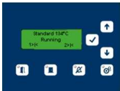
Wyświetlacz po stronie rozładowczej z informacjami o stanie pracy i przyciskami funkcyjnymi lub opcjonalnie ekran dotykowy
