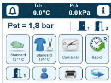
Ekran dotykowy po stronie załadowniczej jako centrala informacyjno - dyspozytorska
