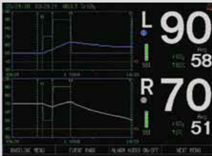
Ekran główny, wyświetlający uśrednianie linii trendu
