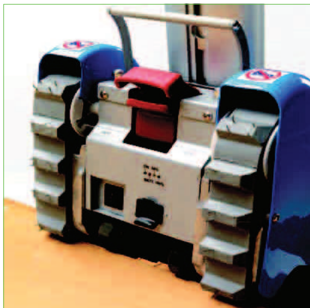
Podwójna blokada, elektryczna i mechaniczna, zaczepu kolumny sterującej do korpusu silnika
