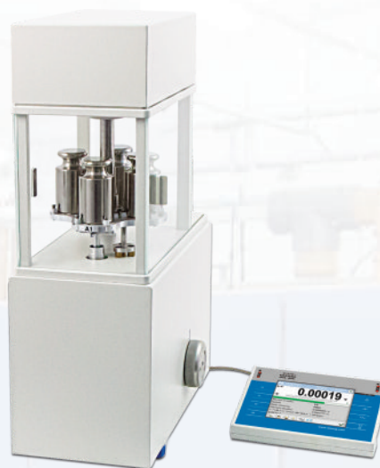
Komparator automatyczny, seria AK-4, d = 0,001 \text{ mg} \div 0,05 \text{ mg}
