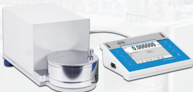
Mikrowaga do ważenia filtrów Seria MYA .4Y.F obszerna, szczelna komora wagowa maksymalna wielkość filtra \phi 100 mm lub \phi 160 mm
