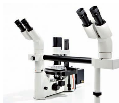
Dodatkowy podgląd dla drugiego obserwatora przy Leica DM IL LED
