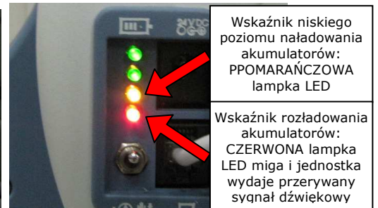
Schemat 4D – Jeżeli wskaźnik świetlny zapala się na POMARANCZOWO lub CZERWONO oznacza to, że poziom naładowania akumulatorów podnośnika jest niski i należy rozpocząć ładowanie.
