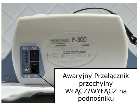
Schemat 14C – CZERWONY przełącznik wyłączania w nagłych wypadkach umieszczony z przodu po lewej stronie podnośnika
