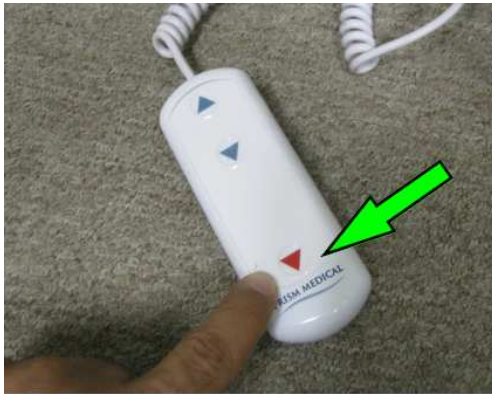
Schemat 14A – CZERWONY przycisk opuszczania w nagłych wypadkach umiejscowiony u dołu pilota sterowana ręcznego
