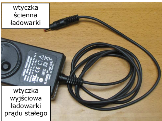
Schemat 12B – ładowarka podnośnika P-136.
