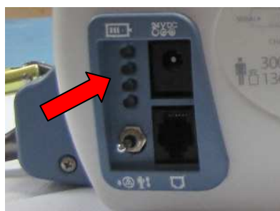
Schemat 4B – wskaźnik świetlny jest zazwyczaj wyłączony, gdy podnośnik nie jest używany.
