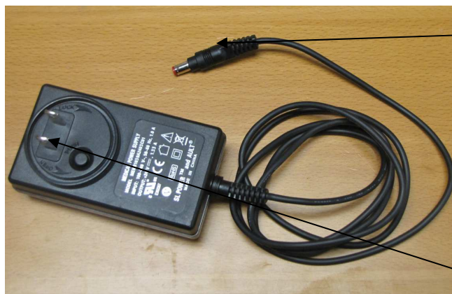
Schemat 3A – Ładowarka do podnośnika P-136
