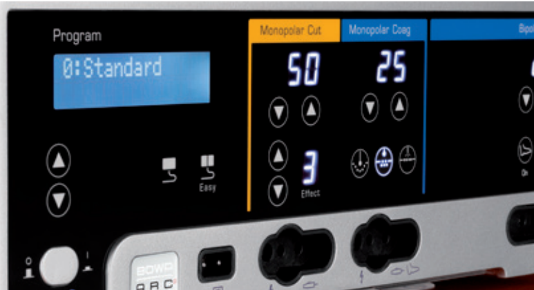
Simultaniczna aktywacja dwóch uchwytów pozwala na wykonanie koagulacji przez dwóch operatorów, np. w kardiochirurgii, ginekologii lub chirurgii urazowej
