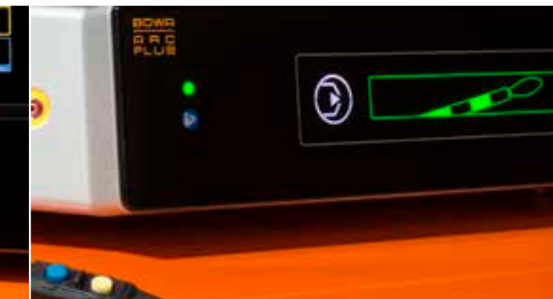
Zielony wskaźnik sygnalizuje wstępne płukanie argonem podłączonych instrumentów
