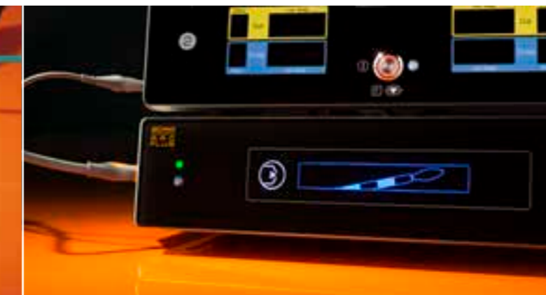
Aktywacja trybów argonowych jest dodatkowo wizualizowana na ARC PLUS
