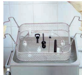
Mycie i dezynfekcja akcesoriów endoskopowych w koszu K 14 z klamrami mocującymi FE 12
