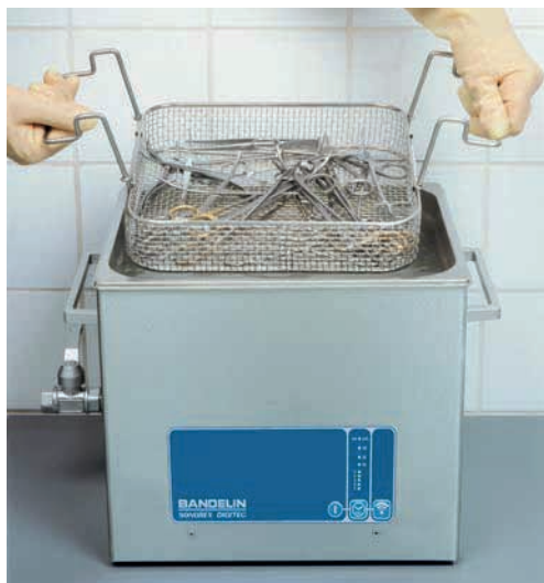
Mycie i dezynfekcja narzędzi medycznych w myjni SONOREX DIGITEC DT 514
