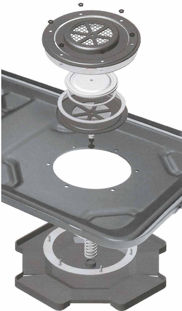
2. Zawór otwarty - w fazie podciśnienia w komorze sterylizatora (ewakuacja powietrza)
