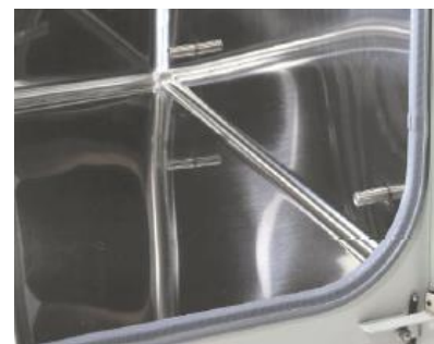
Zaokrąglone rogi dla łatwego czyszczenia komory
