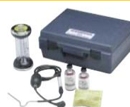
Fyrite – przyrząd do pomiaru CO 2
